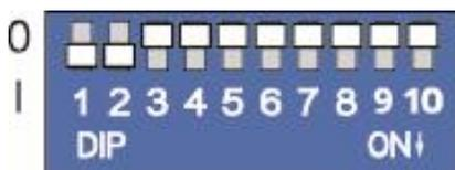
Figura 4: commutatori DIP (Impostazione di fabbrica)
